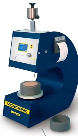
Рисунок 2.2 - Автоматический прибор Вика «Vicatronic» E044N
