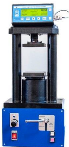
Рисунок 2.3 - Пресс испытательный гидравлический малогабаритный ПГМ-100МГ4
